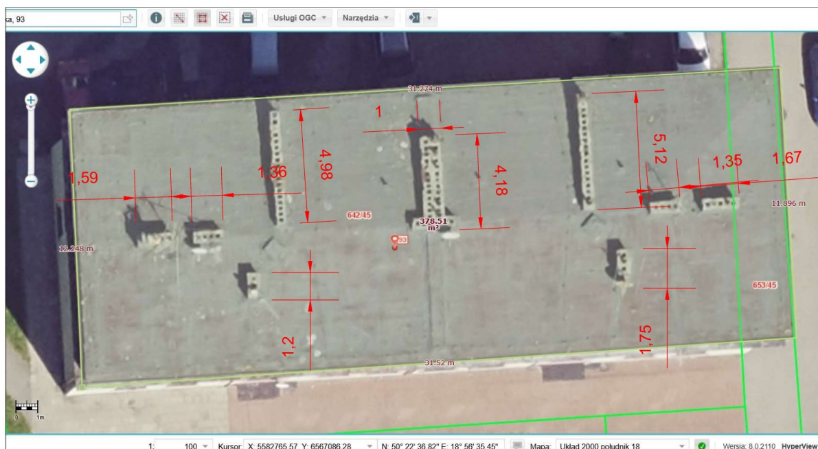
Fot. 2. Widok dachu i pomiary powierzchni kominów.
